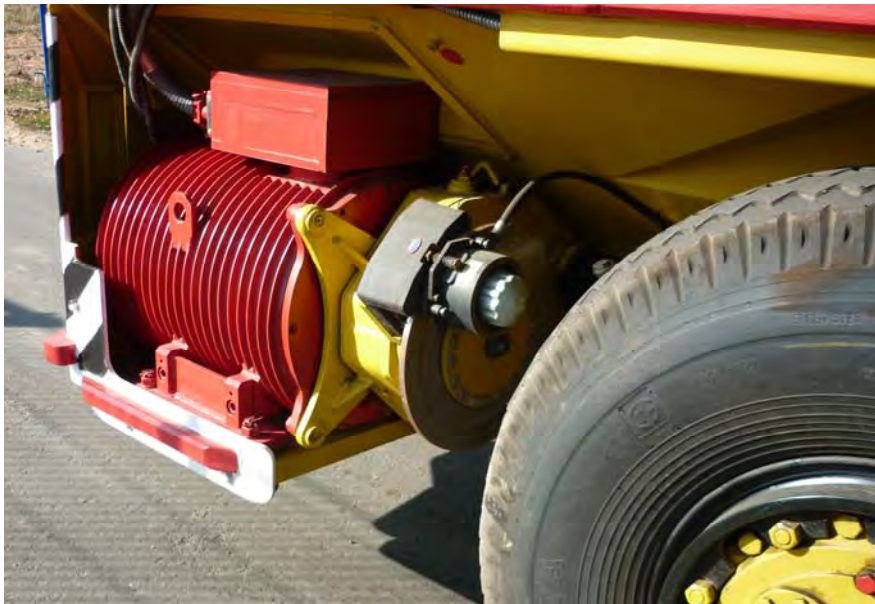
Рисунок 1 – Привод колес шахтного самоходного вагона ВС-17
