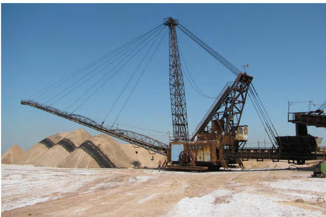
Рисунок 1 - Общий вид отвалообразователя ОШ-75
