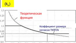
Коэффициент ( $k_l$ ) согласно ТКП EN для многослойных клееных деревянных балок при изгибе и растяжении
