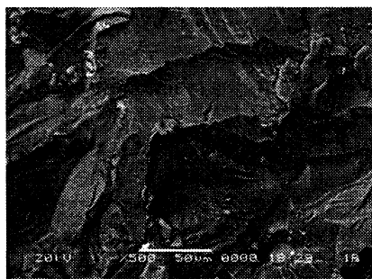
Рис. 3. Усталостный излом сплава, полученного без обработки рафинирующе-модифицирующим комплексом при частоте испытаний 0,3 кГц. ×500
