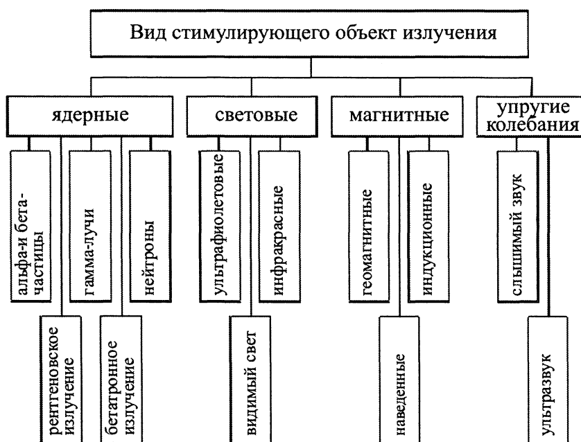
Рис. 1. Виды стимулирующих излучений, применяемых в неразрушающем контроле изделий литейного производства
