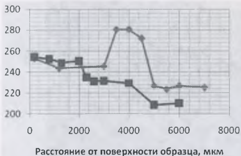
Рис. 1. Микротвердость в сечениях 1 – 1, 2 – 2 образца № 13: ряд 1 – поперечное 1 – 1, от наплавки к центру стержня; ряд 2 – продольное 2 – 2, от края поверхности к центру
