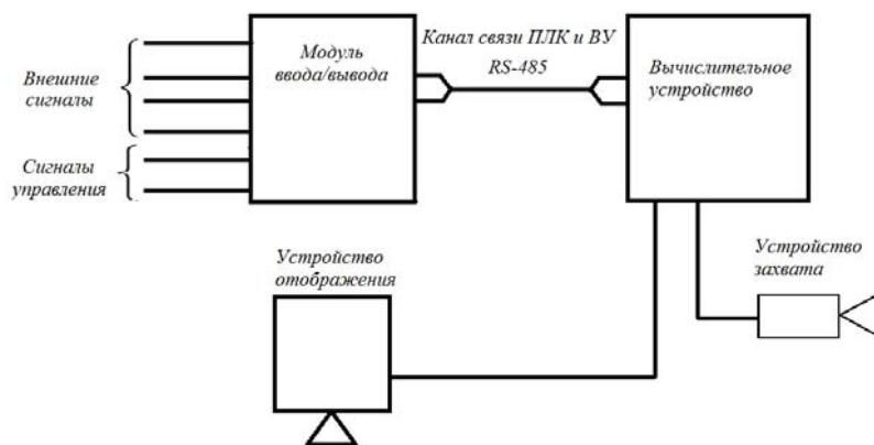
Рисунок 1. Взаимодействие основных элементов системы технического зрения.
