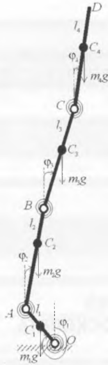
Рисунок 1 — Модель опорной ноги в виде четырехзвенной составной стержневой пружинной системы
