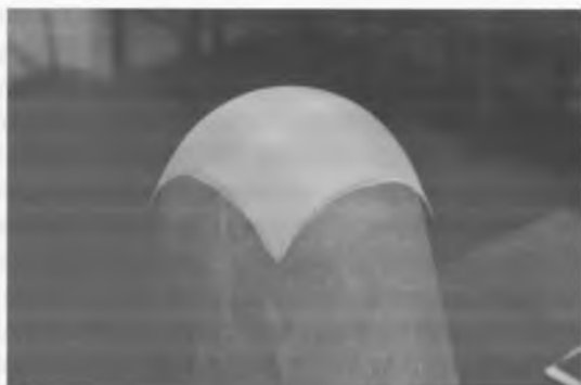
Рисунок 2 — Положение образца ткани на поверхности сферы
