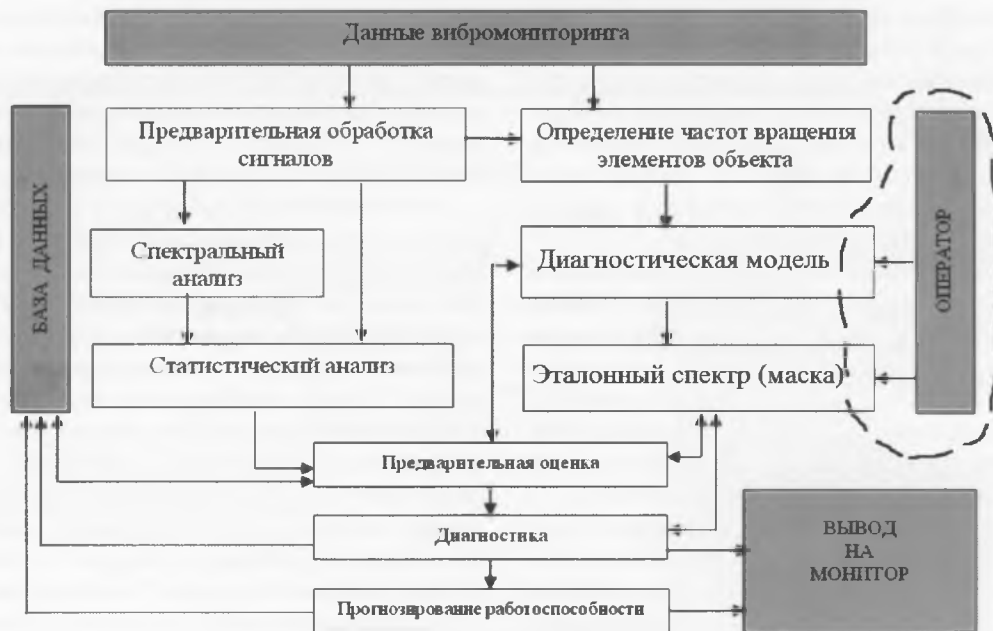
Рисунок 4 — Схема процесса виброакустической диагностики РМК
