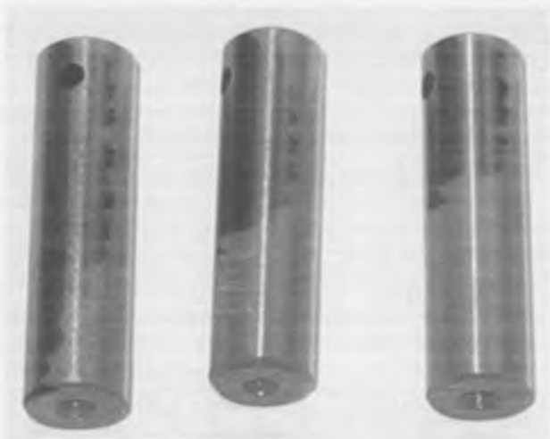
Рисунок 2 — Общий вид установки и образцы, используемые при испытаниях износостойкости трехвалковым методом: а — установка типа I-47-K-54; б — комплект образцов для исследований
