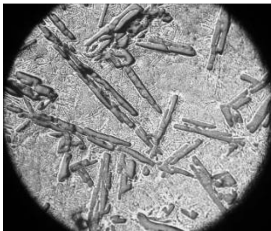
Рис. 4.15. Микроструктура Al-Si лигатуры, полученной из АМК с использованием 50 % кварцевого песка, введенного в расплав в две стадии, \times 50 [107]
