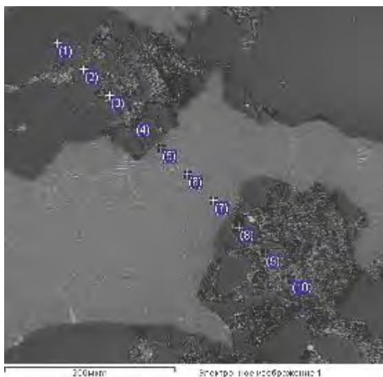
Рис. 2.18. Электронное изображение АМК Al-10%SiO 2
