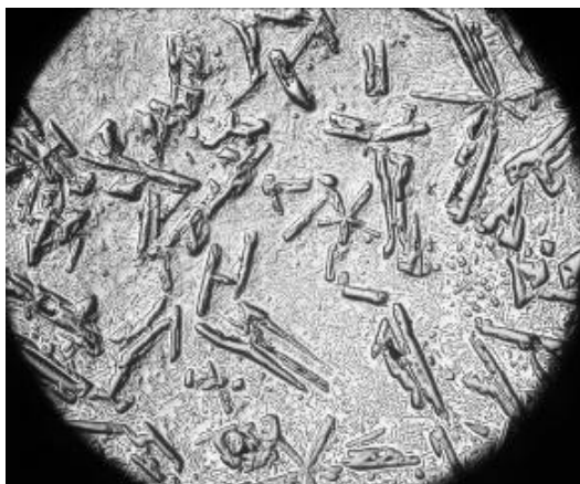
Рис. 4.14. Микроструктура лигатуры, полученной из АМК с использованием 30 % кварцевого песка и 15 % отходов кристаллического кремния, введенных в расплав отдельно в две стадии, \times 50 [107]
