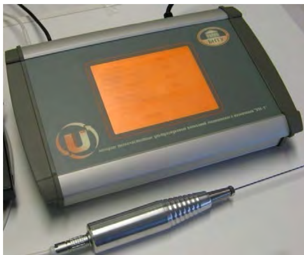
Рисунок 2.8 – Ультразвуковой генератор для проведения испытаний на усталостную прочность
