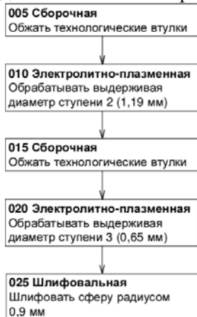
Рисунок 5.12 – Последовательность операций в процессе формообразования поверхностей концентраторов-инструментов методом размерной ЭПО
