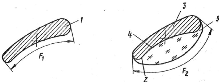
Детали 1 и 3 обрабатывают на одном станке и сравнивают координаты исследуемых точек деформируемой детали 1 и недеформируемой детали 3 с помощью, например, измерительного микроскопа. По изменению координат исследуемых точек судят о величине деформаций деформируемой детали 1. Такой подход позволяет повысить точность определения деформаций за счет увеличения жесткости детали.
