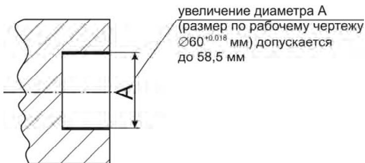
Рис. 1.1. Подготовка детали к ремонту
