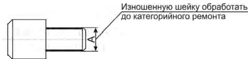
Рис. 1.4. Обозначение категориальных ремонтных размеров
