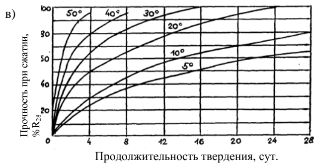
Рис. 1.7. Кривые набора прочности бетона при различных температурах его выдерживания: а, в – бетон М200 на портландцементе активностью 400...500; б, г – бетон М200 на шлакопортландцементе активностью 300...400
