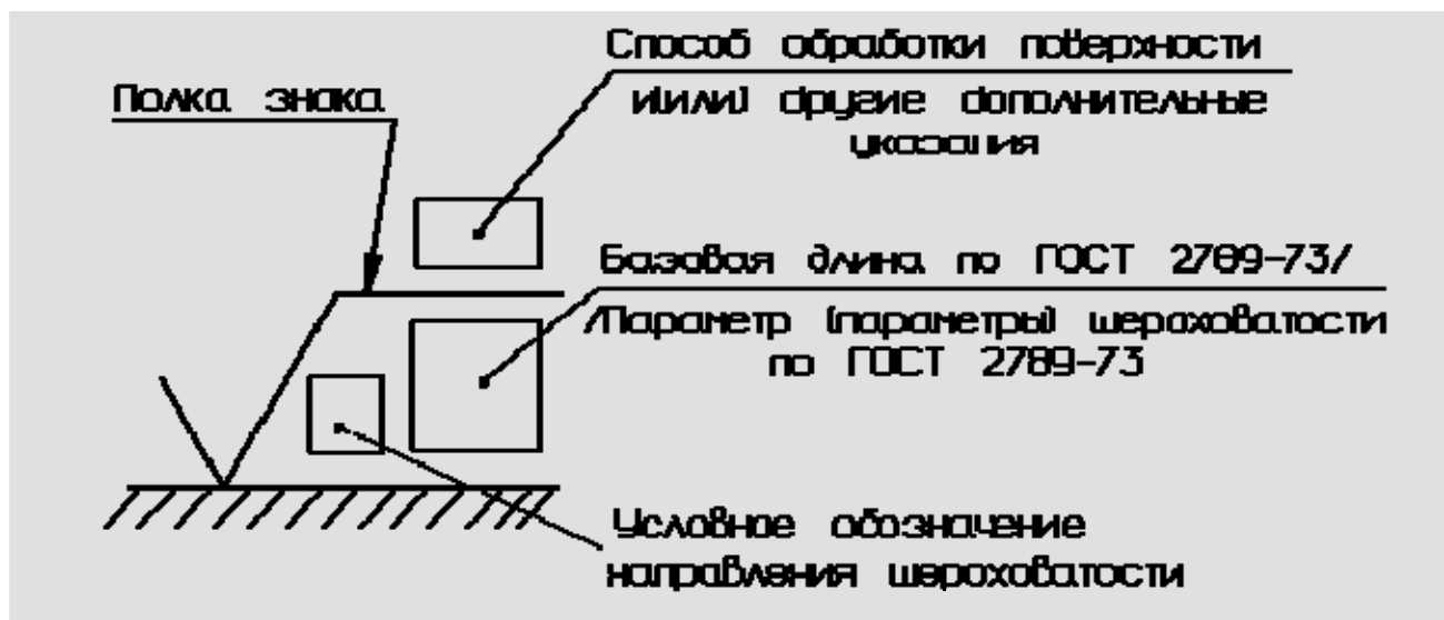
Рисунок 8.1 – Структура обозначения шероховатости поверхности
