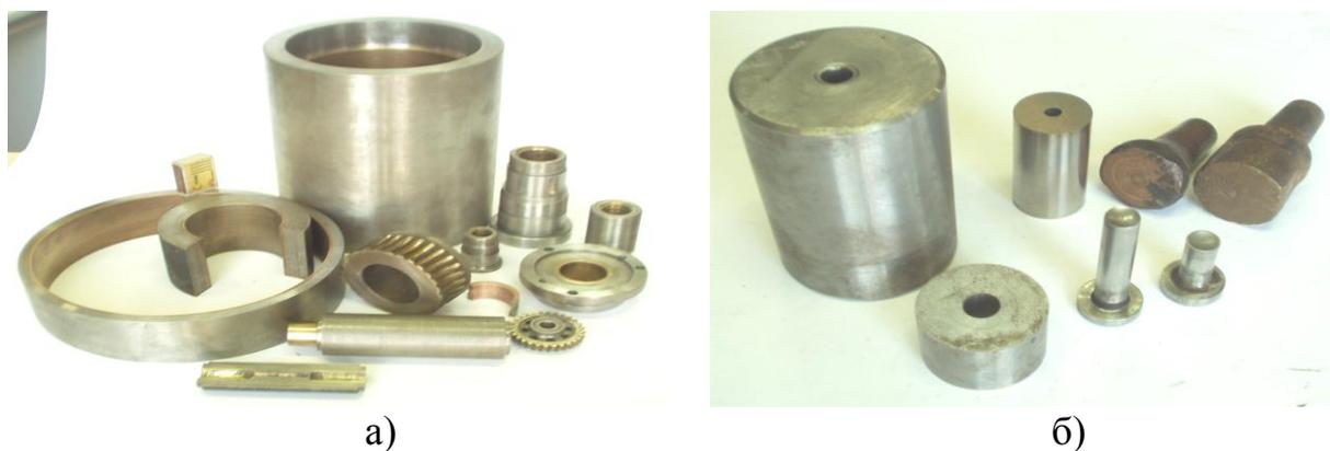
**Рисунок 1 – Детали с функциональными покрытиями, полученные а – индукционной и б – электроконтактной наплавкой**
