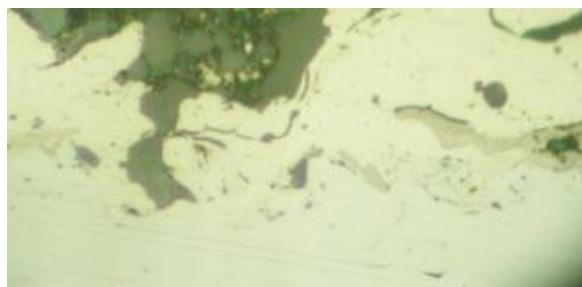
Рисунок 3 – Микроструктура границы раздела композиционных покрытий со стальной основой
