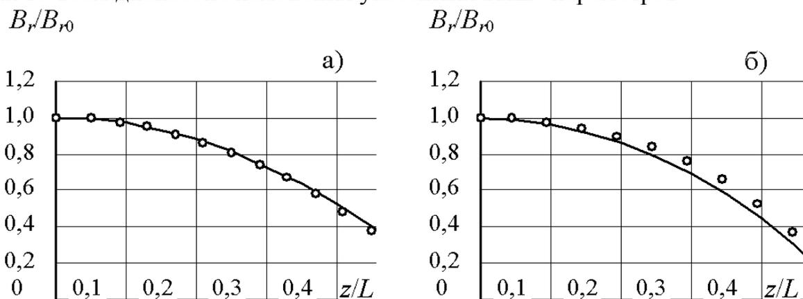
○ – эксперимент и численный расчет; — расчет по формуле
