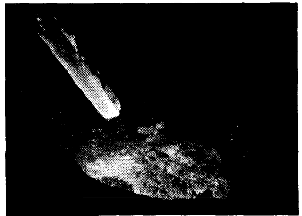
Рис. 5. Расплав чугуна с использованием в шихте брикетов (повышенное содержание шлаков)
