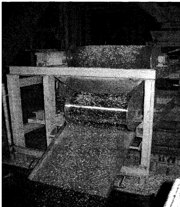
Рис. 3. Устройство двойной сепарации магнитных и слабомагнитных включений (нирезиста) в алюминиевой стружке (ПРУП «Минский моторный завод»)
