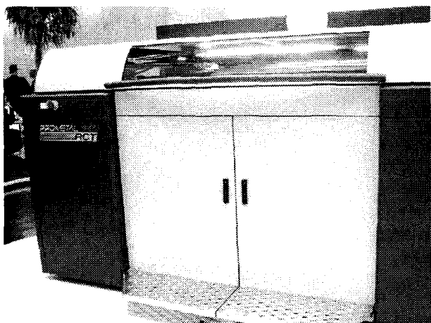
Рис. 19. Оборудование фирмы ProMetal RCT GmbH (Германия) для цифрового производства песчаных форм и стержней
