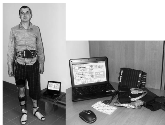
Рисунок 3 – Внешний вид системы многоканальной электромиографии и подографии
