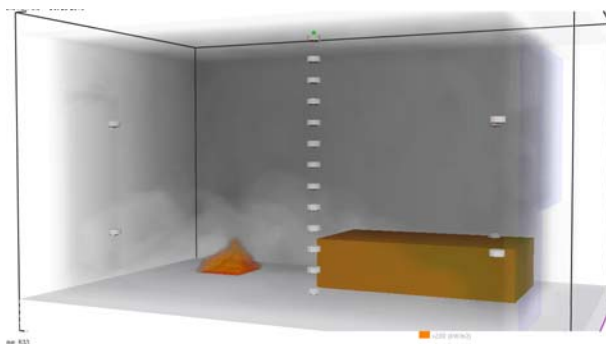
Рис. 3.1. Картина на 114-й секунде пожара мощностью 50 кВт в закрытой комнате, потолок и стены которой сделаны из дерева
