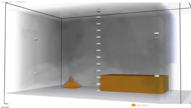
Рис. 2.8. Картина на 114-й секунде пожара мощностью 50 кВт в закрытой комнате, потолок и стены которой сделаны из бетона
