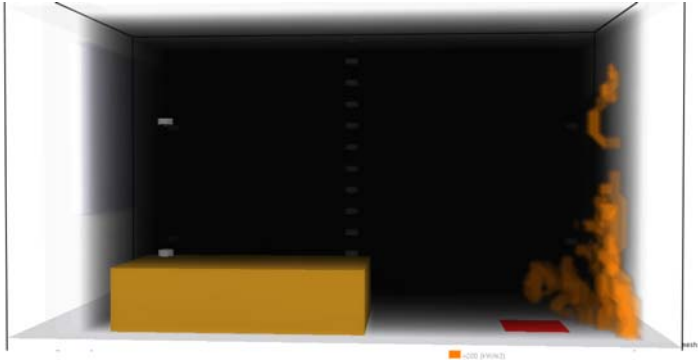
Рис. 4.3. Вид комнаты, стены и потолок которой сделанной из дерева, на 110-й секунде пожара мощностью 250 кВт
