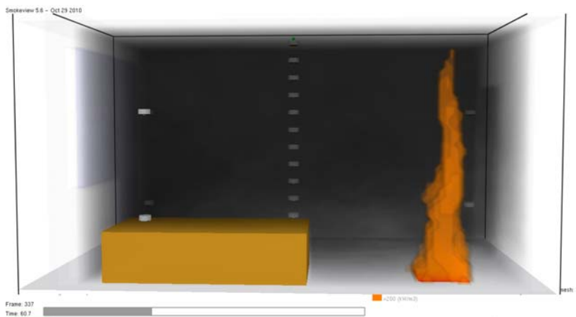
Рис. 4.2. Вид комнаты, стены и потолок которой сделанной из дерева, на 60-й секунде пожара мощностью 250 кВт
