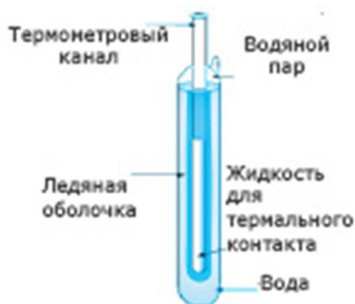
Рисунок 6 – Реализация температуры тройной точки воды
