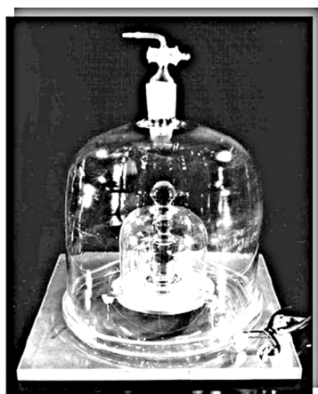
Рисунок 2 – Международный прототип килограмма
