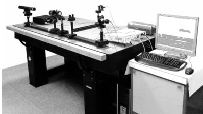
Рисунок 10 – Комплекс установок для измерения спектральных характеристик широкополосных (а), многомодовых (б) и одночастотных (в) лазеров
