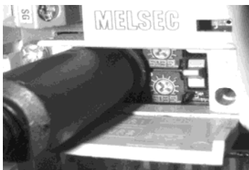
Рис. 2.10. Переключатель работы контроллера
