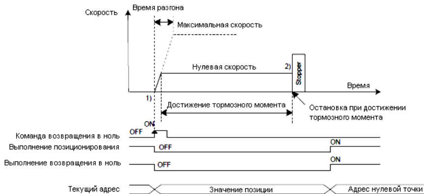
Рис. 4.26. Принцип работы Stopper 2 – режима возвращения нуля
