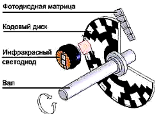
Рис. 4.5. Конструкция абсолютного энкодера
