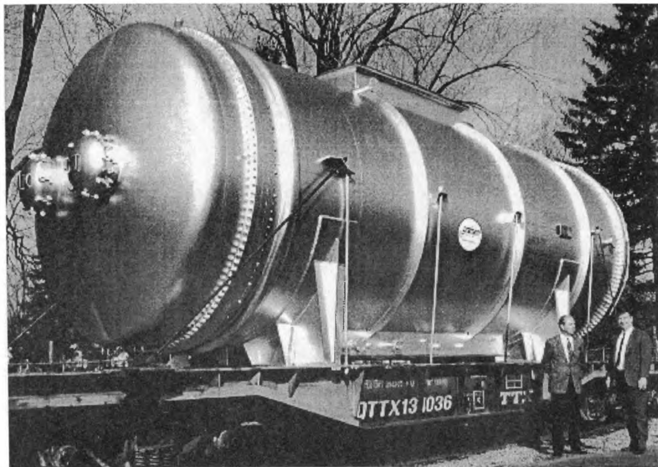
Рис. 5. Конденсатор пара технологической установки во время транспортировки
