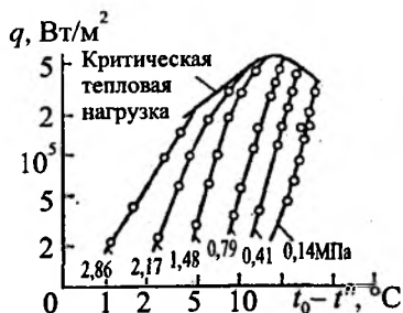
Рис. 3.109. Влияние давления на теплоотдачу при пузырьковом кипении n-пентана при различных давлениях (кипение в большом объеме)
