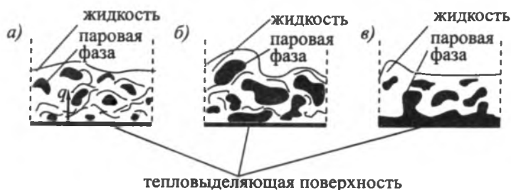
Рис. 3.1. Процесс кипения жидкости: а – пузырьковое кипение; б – переходный режим кипения; в – пленочный режим кипения
