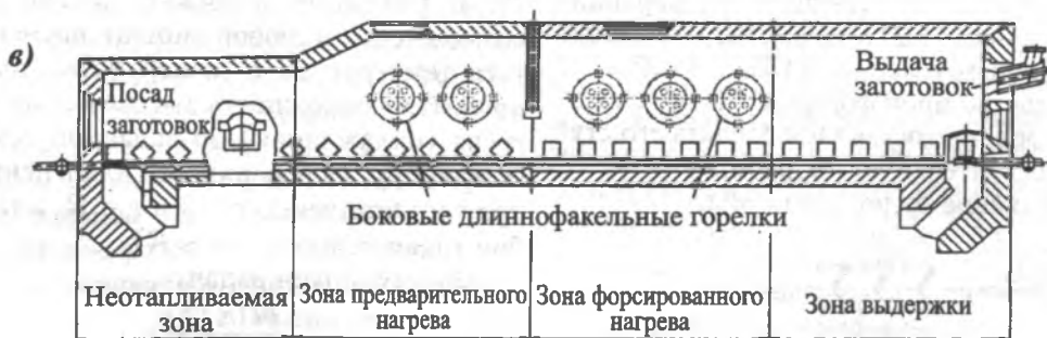
Рис. 1.11. Симметричный нагрев стального бруса в нагревательной печи с шагающими балками прокатного стана 150: а – заготовка на выдаче из печи; б – заготовка после выгрузки из печи; в – схема нагревательной печи стана 150
