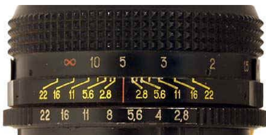
Рисунок 2 – Шкала для определения границ резко изображаемого пространства для объектива «Волна-3» с фокусным расстоянием 80 мм в фотоаппарате «Киев 88» [7]
