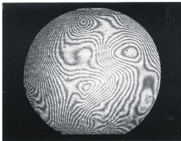
Рисунок 3 – Интерферограмма пластины, имеющей несферическую форму изгиба
