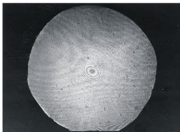
Рисунок 2 – Интерферограмма пластины, имеющей сферическую форму изгиба
