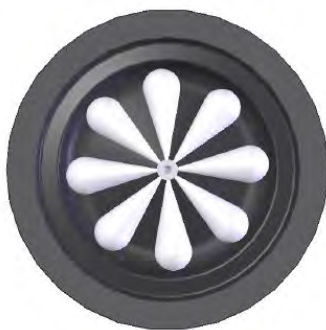
Рисунок 5 – Развитие топливных струй в плане для дизельного топлива и 50 % смеси
