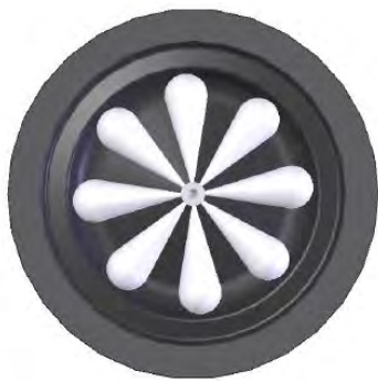
Рисунок 5 – Развитие топливных струй в плане для дизельного топлива и 50 % смеси
