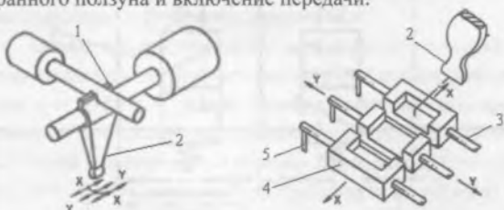
Рис.3. Расположение пневмоцилиндров ИМ и вид в плане на ползуны КП
