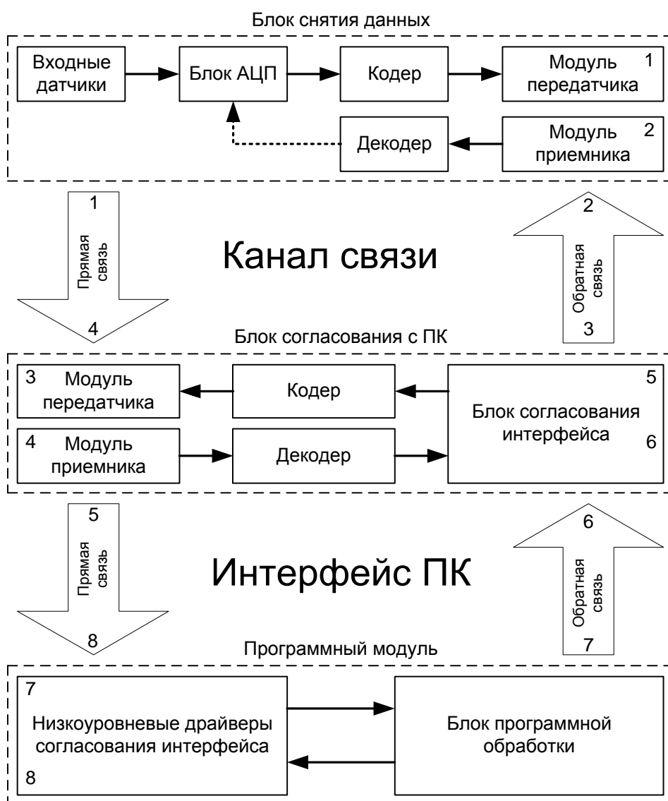
Рисунок 4 – Структурная схема мобильной установки
