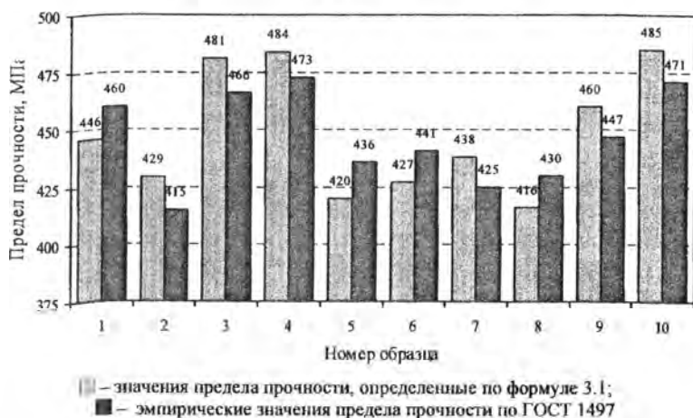
Рисунок 3.6 — Сравнение значений предела прочности стали 09Г2С, определенных по формуле 3.1 и ГОСТ 1497
