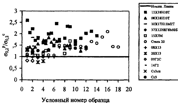
Рисунок 4.1 – Результаты оценки годности исследованных материалов по отношению: пределов прочности \sigma_B^p / \sigma_B^c (а); пределов текучести \sigma_{0,2}^p / \sigma_{0,2}^c (б)
