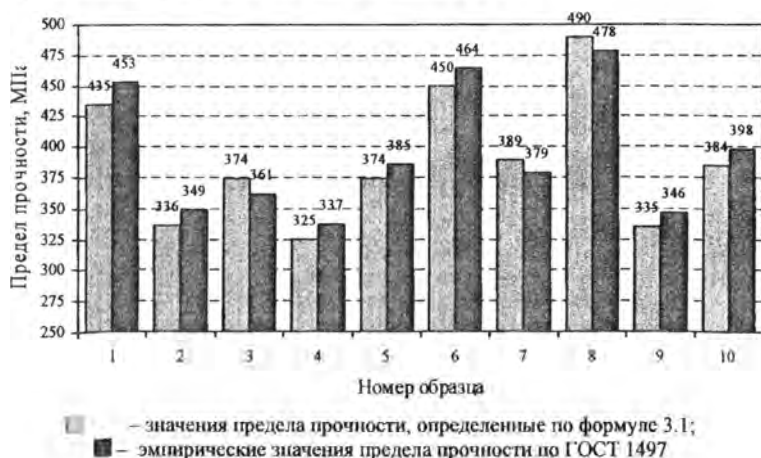
Рисунок 3.5 — Сравнение значений предела прочности стали 20, определенных по формуле 3.1 и ГОСТ 1497
