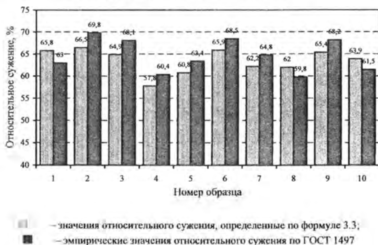
Рисунок 3.15 – Сравнение значений относительного сужения стали 20, определенных по формуле 3.3 и ГОСТ 1497
