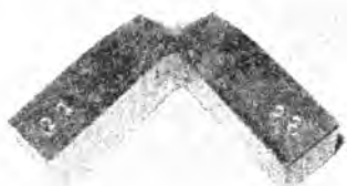
Рисунок 3.2 – Фотография образца (после испытания на ударный изгиб по ГОСТ 9454), на котором определялись параметры индентора
