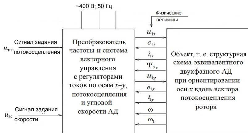
Рис. 3. Обобщенная структура векторного управления АД при ориентировании оси x вдоль вектора потокосцепления ротора
