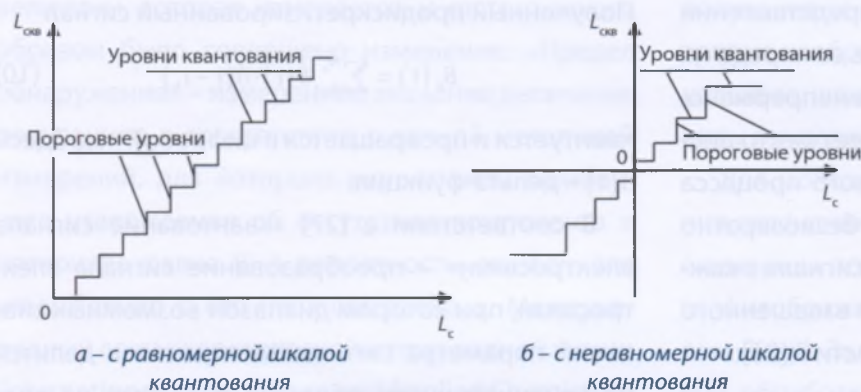
Рисунок 6 – Амплитудные характеристики квантующих устройств
