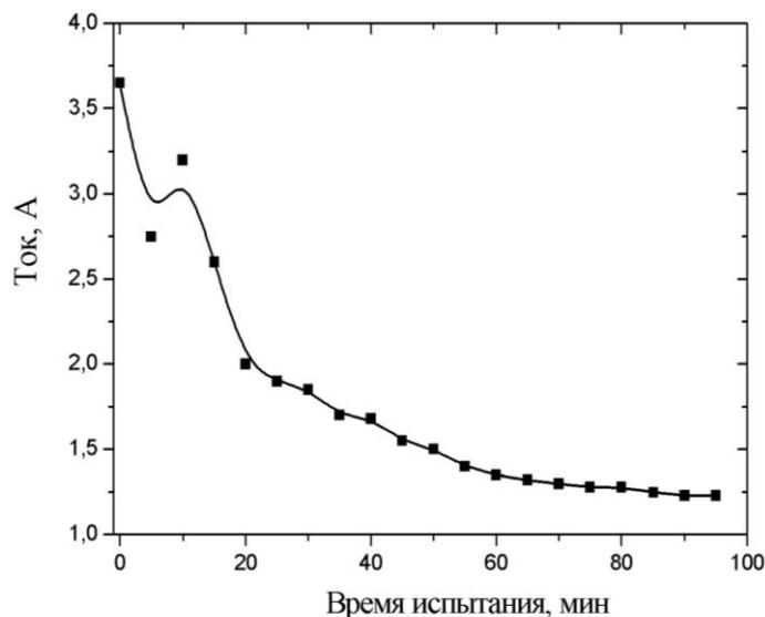
Рисунок 5 – Зависимость потребления тока от времени испытания № 2
