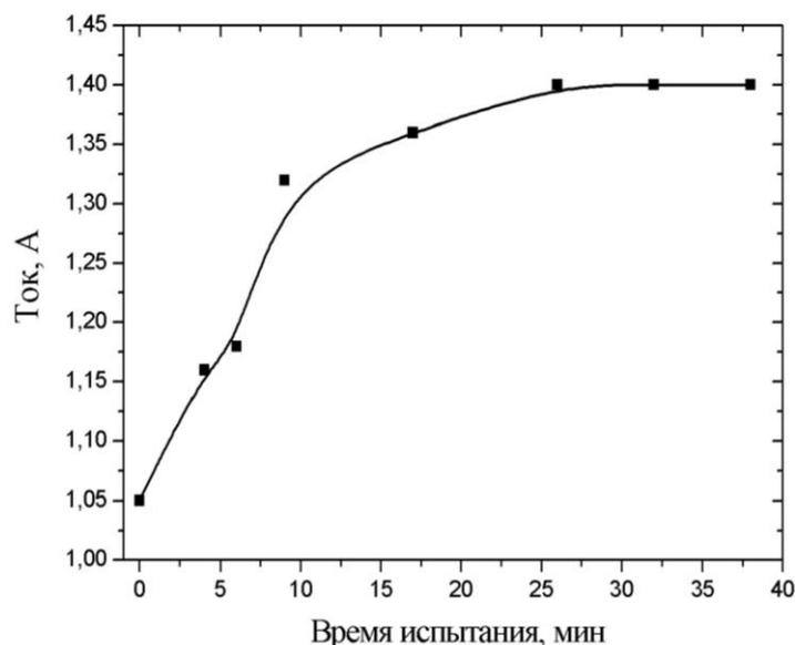
Рисунок 7 – Зависимость потребления тока от времени испытания № 3
