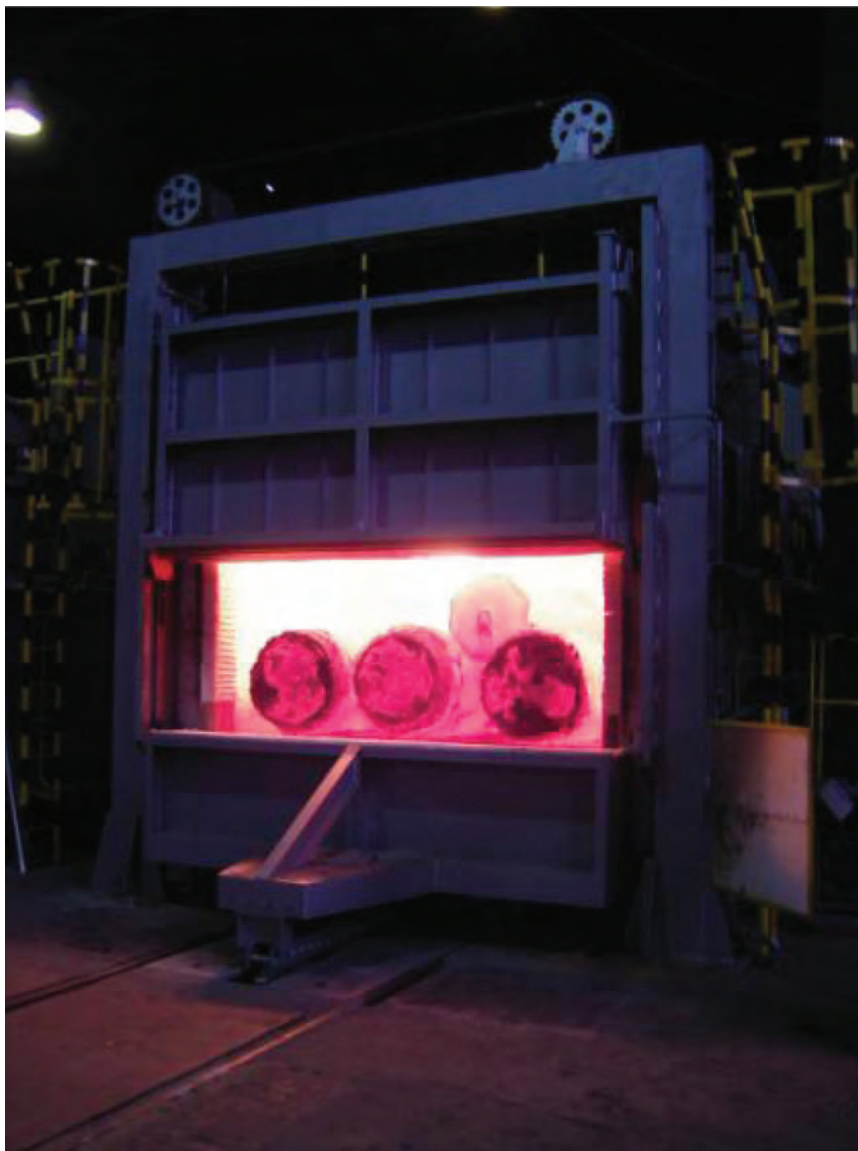
Рис. 1. Печь с выкатным подом размером 3,4×2×5,7 м с предварительным нагревом воздуха
