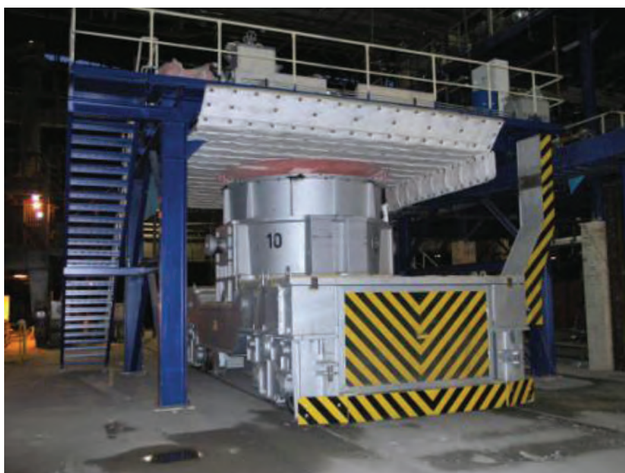
Рис. 2. Стенд нагрева ковшей
