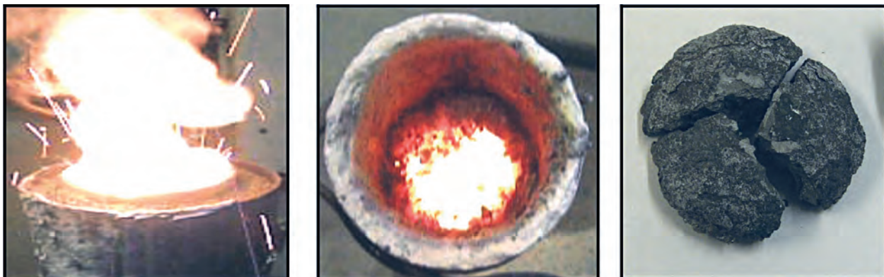
Рис. 2. Процесс восстановительной плавки: а – начало процесса; б – завершение процесса; в – слиток лигатуры
