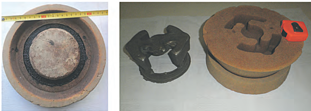
Рис. 1. Вид отливки и формы с нанесенным покрытием
