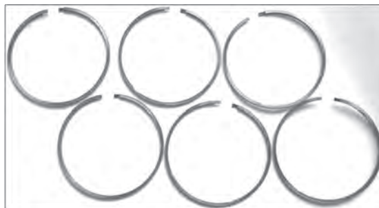
Рис. 3. Примеры уплотнительных колес трансмиссии тягача МЗКТ диаметром 82 мм, изготовленных из горячедеформированных заготовок высокопрочного чугуна
