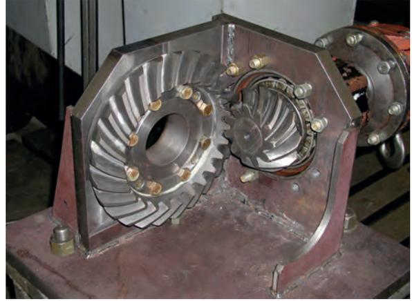
Рис. 6. Шестерни главной передачи МАЗ-5551 из бейнитного чугуна на стенде испытаний на статическую изгибную прочность (шестерня слева жестко закреплена, шестерня справа медленно вращается)
