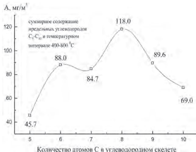
Рис. 5. Изменение суммарного содержания предельных углеводородов C 5 –C 10 в температурном интервале 400–800 °C
