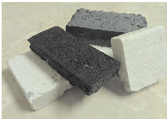
Рис. 4. Образец пеносиликатного материала на основе щелочно-силикатной композиции
