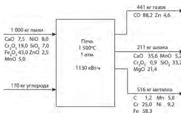
Рис. 6. Прогнозный материально-тепловой баланс для пыли из легированной стали (результаты анализа приведены в процентной концентрации по массе)
