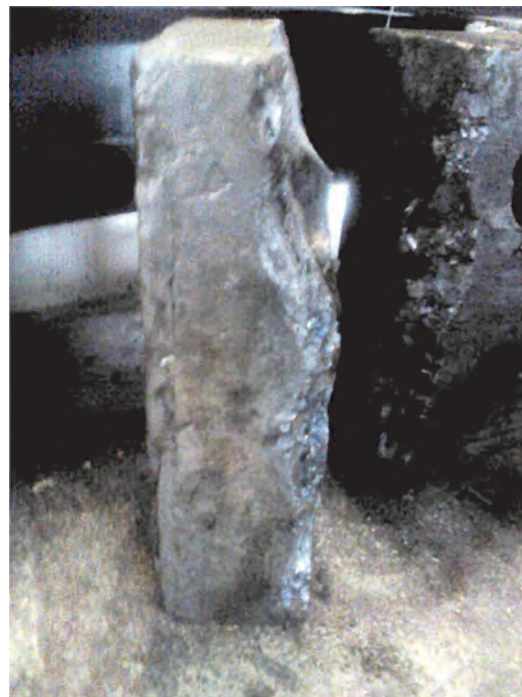
Рис. 2. Характер износа ножей из стали 1.2746, EN ISO4957, вид с торца
