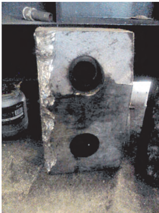
Рис. 1. Характер износа ножей из стали 1.2746, EN ISO4957, вид сбоку
