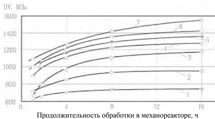
Рис. 2. Влияние продолжительности обработки в механореакторе на твердость гранулированного алюминия (1) и композиций, легированных ZrO_2 (2), Cr_2O_3 (3), MoO_3 (4), H_2O (5), CuO (6), CO_2 (7)
