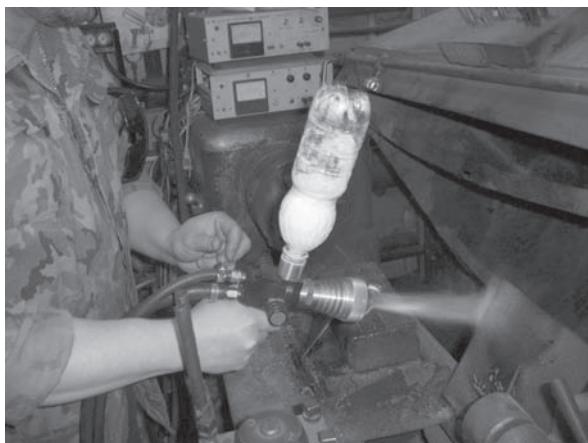
Рисунок 1 — Внешний вид термораспылителей: а — порошковый ОИМ 050; б — шнуровой ТЕРКО-ПШ
