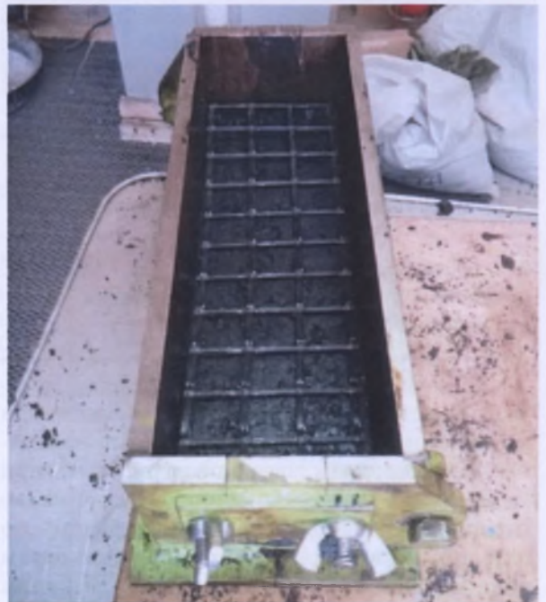
Рисунок 6 – Геосетка, уложенная на нижний слой асфальтобетона
