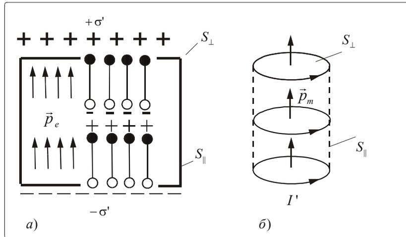
1.4.4 Моделирование поляризованного тела пустотной полостью.
