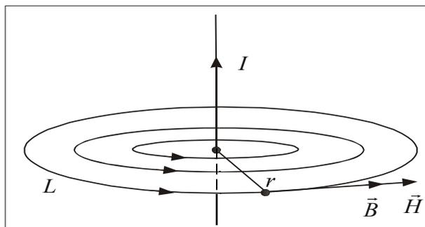
1.12.4 Ротор вектора  $\vec{H}$  в вихревом магнитном поле тока проводимости
